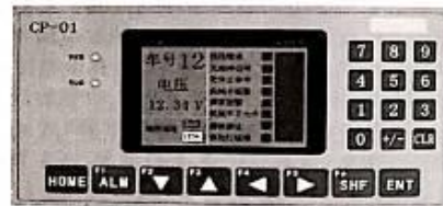
图1 AGV系统控制面板
